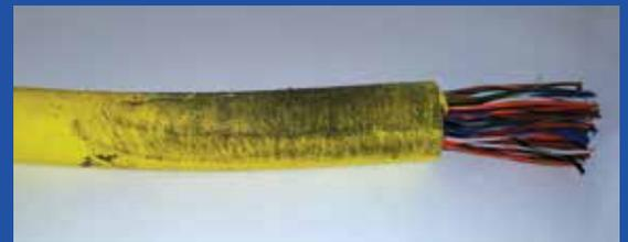
El cable que aparece en esta imagen soportó el peso de una plataforma oruga de 60,000 libras. Cuando la prueba inicial no causó ningún deterioro, realizamos un giro de cero grado al rotar directamente el cable. El único daño registrado fue la cubierta exterior desgastada.
